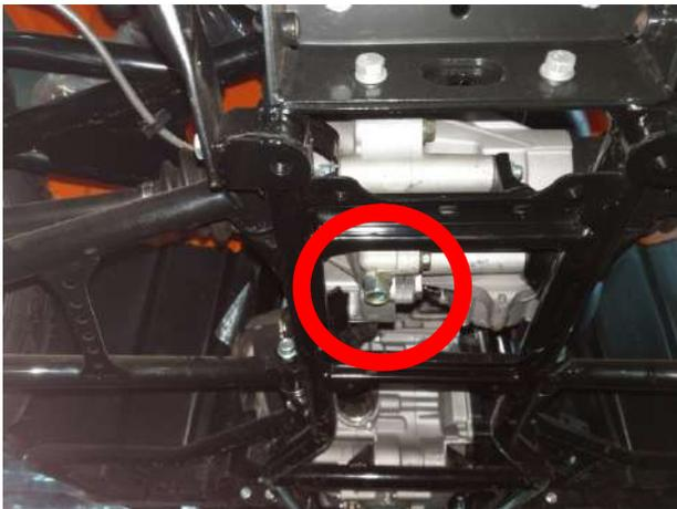
3. 使用 17mm 板手移除注油孔螺絲，從注油孔使用漏斗緩慢添加齒輪油，前齒輪箱注入齒輪油油量 280ml，注入後鎖緊螺絲以及墊片(扭力值為 30N-m)
