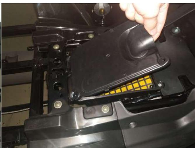
3. 將空濾盒中，將固定網的 8 顆十字螺絲移除，取出濾心綿，並置入新的(或清潔過的)濾心綿並將濾心固定網片鎖回(無需過緊)，將盒子上蓋鎖回，以完成此次更換空濾棉作業
