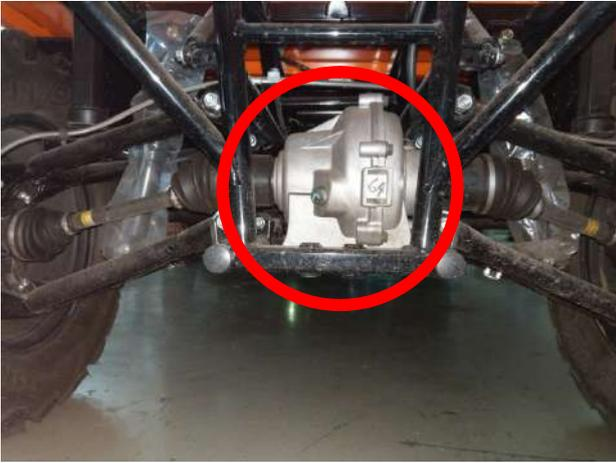
2. 找到後橋齒輪箱泄油孔螺絲，在後橋齒輪箱體底部，使用 17mm 板手放鬆螺絲，進行洩油；洩完油後，將洩油螺絲以及墊片鎖付（鎖付扭力為 25N-m）
