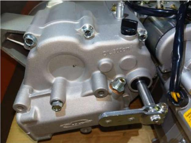
2. 於引擎齒輪箱下方，可找到齒輪箱洩油螺絲使用 12mm 板手放鬆螺絲，進行洩油；洩完油後，將洩油螺絲以及墊片鎖付(鎖付扭力為 10-15N-m)
