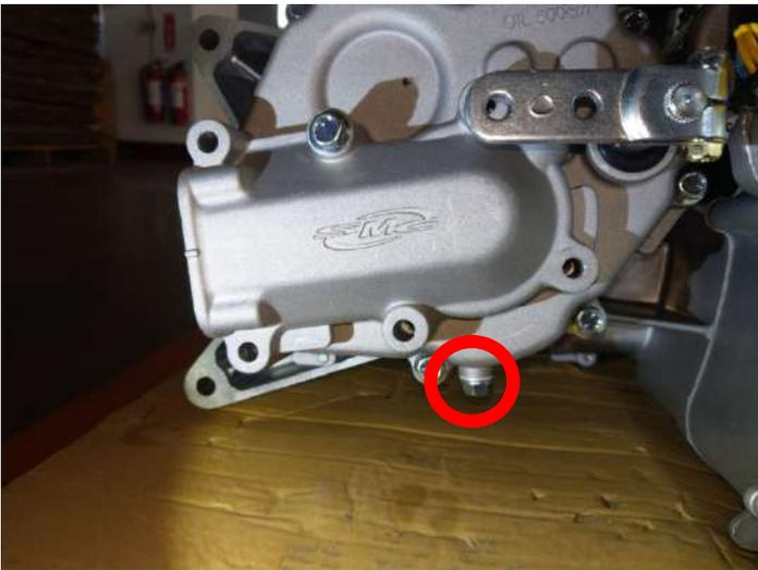
3. 逆時針旋轉移除注油塞，並使用漏斗加入 500ml 的齒輪油，加完齒輪油後，將注油塞旋緊即完成此更換引擎齒輪油作業
