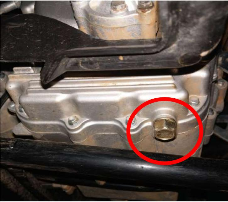
3. 在車輛引擎右側找到注油塞, 逆時鐘旋開, 並添加 1.4L 機油, 添加完後旋入注油塞, 從機油量檢視孔檢查是否在上限以及下限位置, 不足時應予以添加機油, 確認機油量足夠後, 旋緊注油塞以完成機油更換作業
