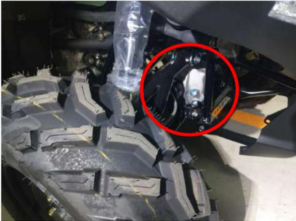
2. 找到前橋齒輪箱洩油孔螺絲，在前橋齒輪箱體底部，使用 17mm 板手放鬆螺絲，進行洩油；洩完油後，將洩油螺絲以及墊片鎖付(鎖付扭力為 25N-m)
