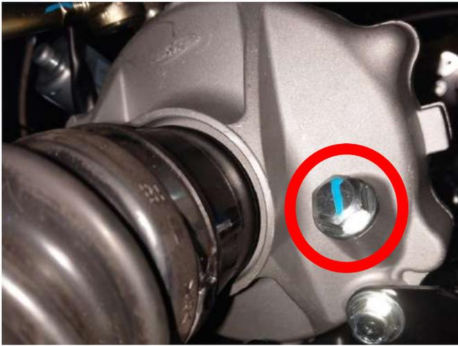
水牛牌 300 型、400 型、400s 型搬運車，後齒輪箱更換齒輪油：
