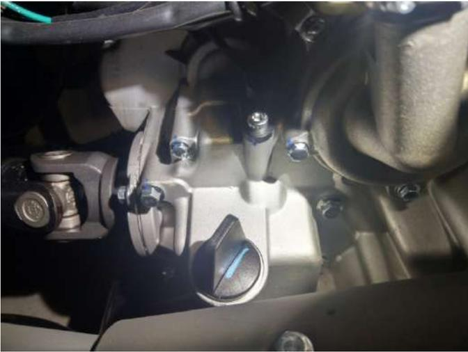
2. 在引擎本體下方找到洩油螺絲(鍍金色),使用 14mm 板手放鬆螺絲,進行洩油;洩完油後,將洩油螺絲以及墊片鎖付(鎖付扭力為 30N-m)
