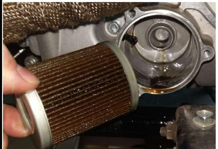
2. 注意機油濾心安裝方向，圓孔較大者在引擎內側，且務必推至定位，將濾心安裝後，返工完成此次
