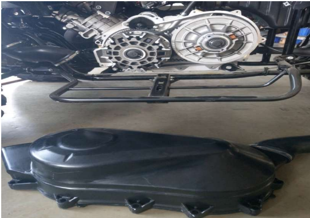
6. 使用特工副滑動槽輪拆卸螺栓(8-25660-ML8-00), 使用 13mm 六角板手順時針鎖付後移除皮帶
